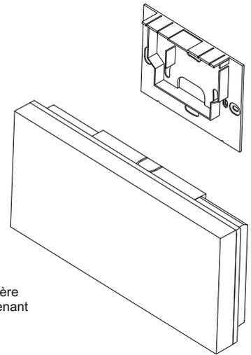
Le luminaire est composé d'une patère de fixation et d'une enveloppe contenant l'électronique et les batteries.
