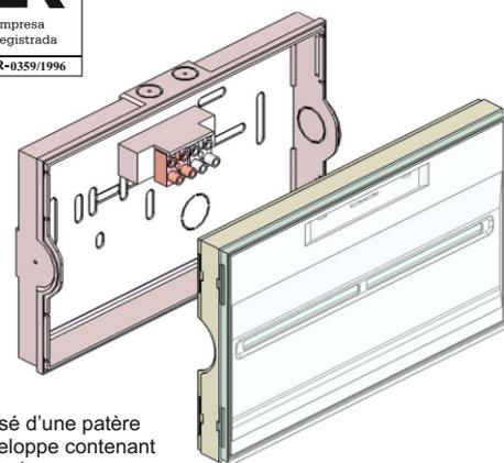
Le luminaire est composé d'une patère de fixation et d'une enveloppe contenant l'électronique et les batteries.
