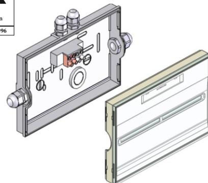
Le luminaire est composé d'une patère de fixation et d'une enveloppe contenant l'électronique et les batteries.
