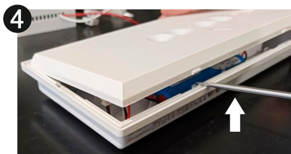
A l'aide d'un tournevis, retirer le réflecteur, en faisant levier, comme indiqué sur la photo.
