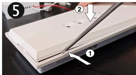
A l'aide d'un tournevis, retirer le réflecteur, en faisant levier, comme indiqué sur la photo.
